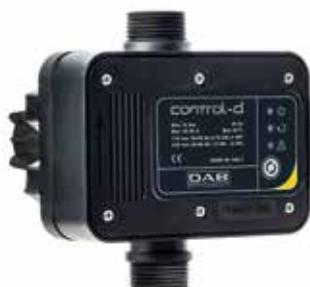
Dispositivos electrónicos on/off para el control y protección de bombas monofásicas. Diseñados para controlar automáticamente el arranque y el paro de la bomba, además de detenerla en caso de funcionamiento en seco y función antibloqueo con rearme automático.
