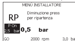
Figura 17: Impostazione della pressione di ripartenza
