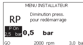
Figure 17 : Réglage de la pression de redémarrage
