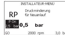
Abbildung 17: Einstellung des Neustartdrucks
