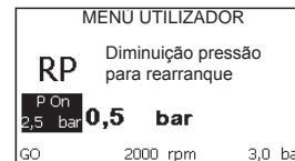
Figura 17: Programação da pressão de rearranque
