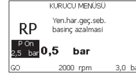
Şekil 17: Yeniden başlatma basıncının ayarlanması
