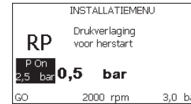
Afb. 17: Instelling van de herstartdruk
