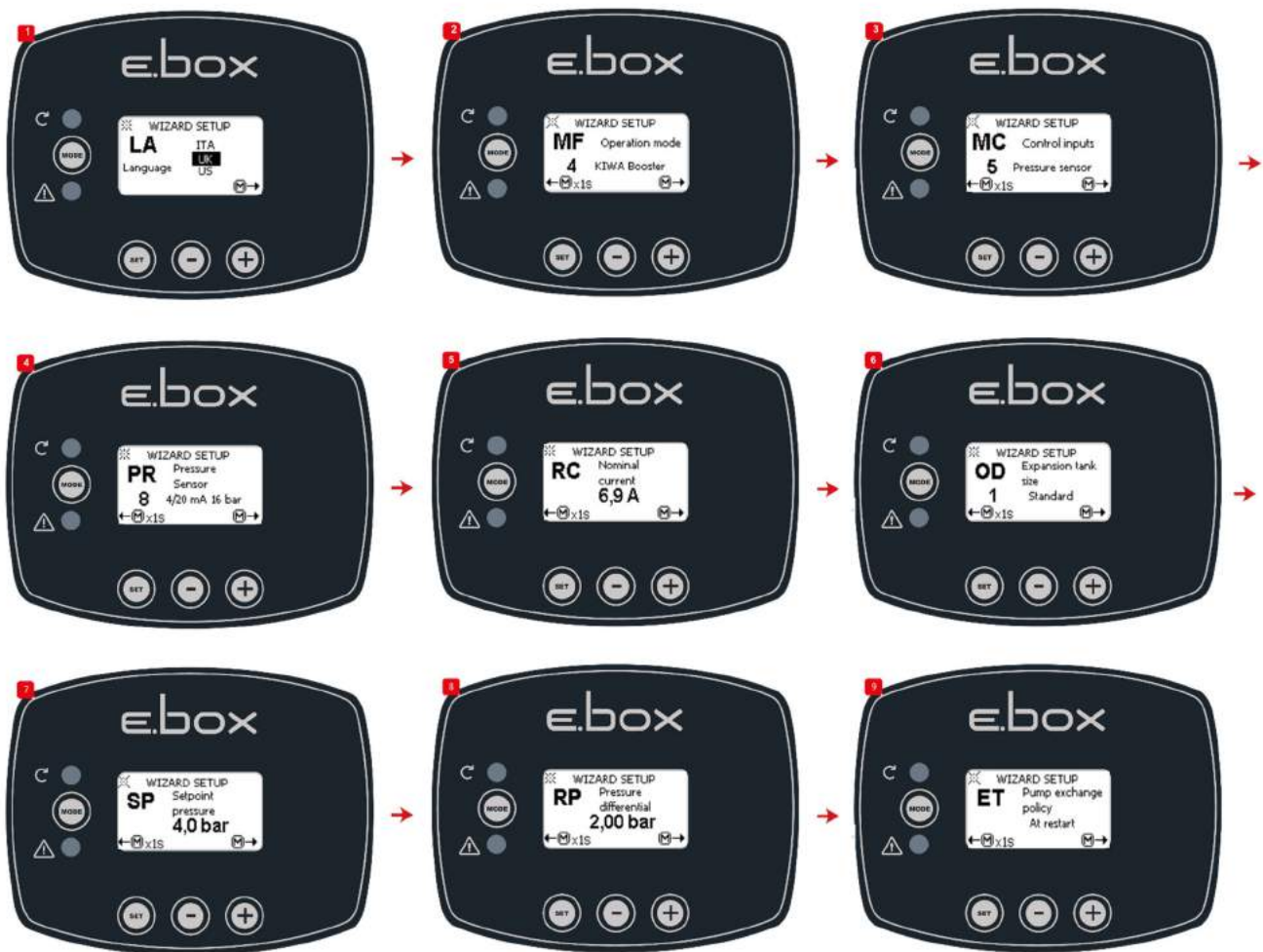
Figura 48: Presurizare KIWA cu senzor de presiune
