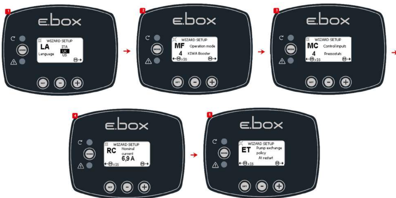
Figura 49: Configurazione Kiwa con Pressostati
