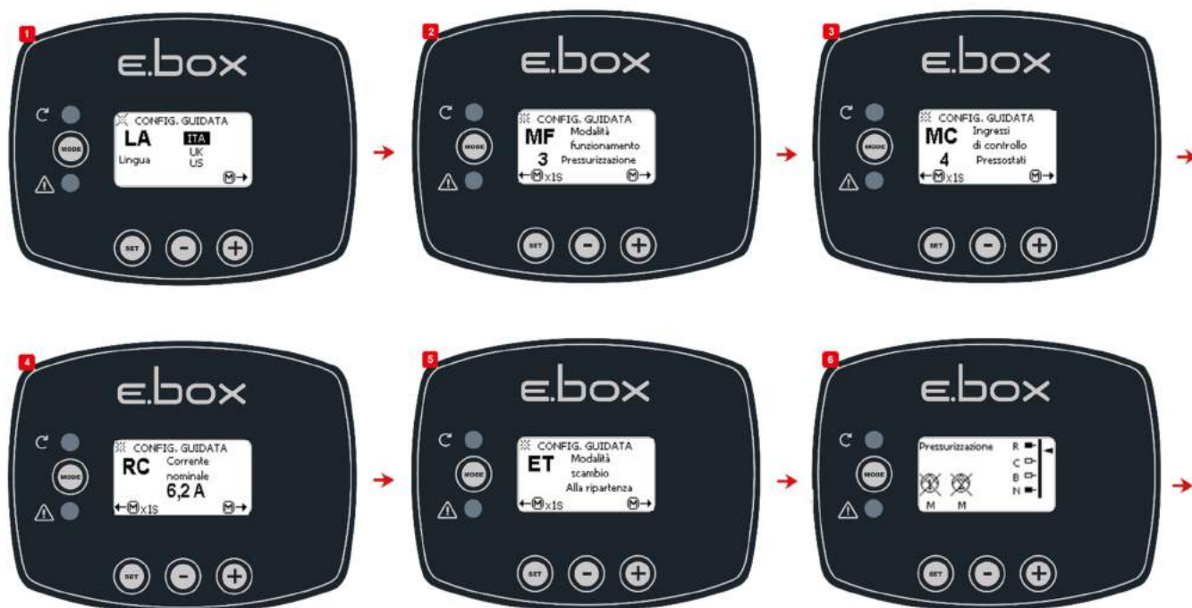
Схема 13: Конфигурация с реле давления
