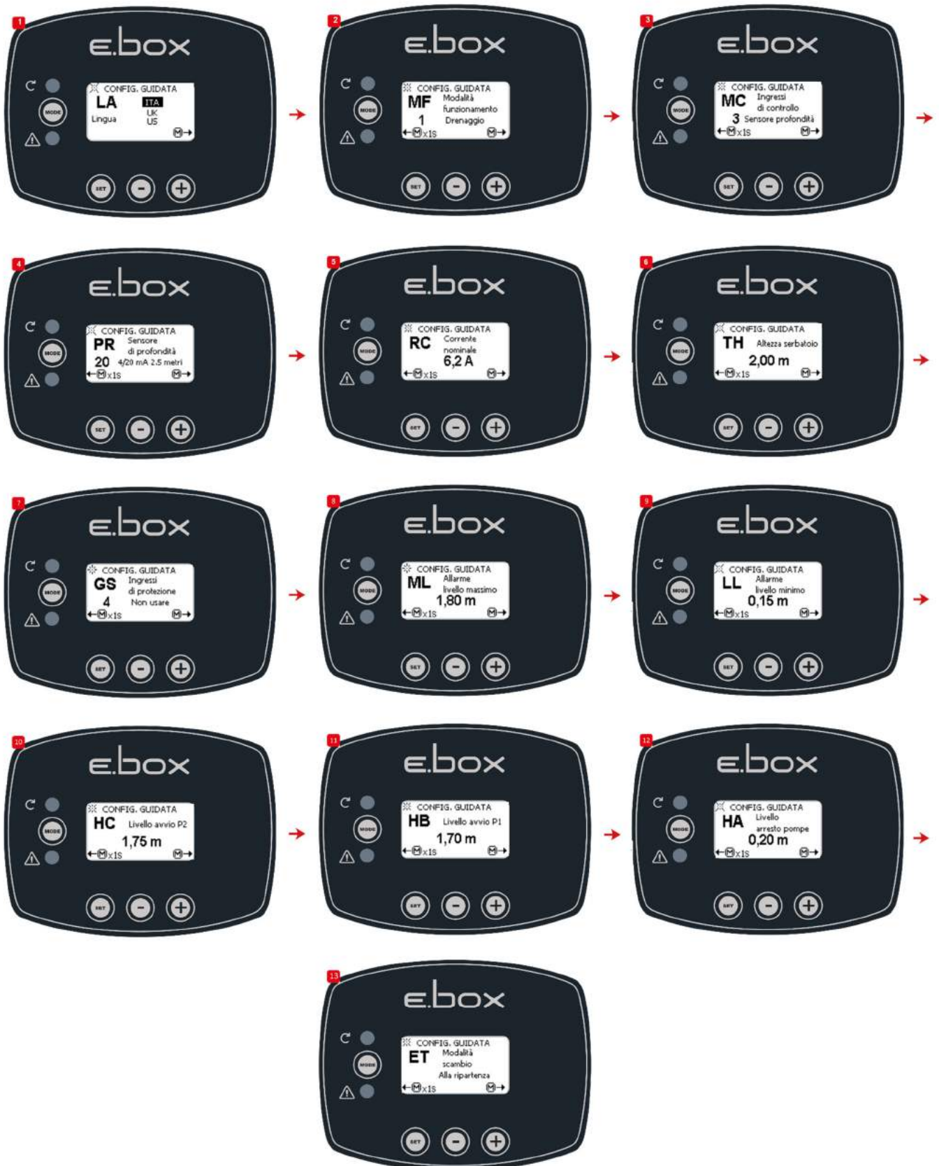
Obrázek 38: Nastavení pouze s hloubkovým čidlem
