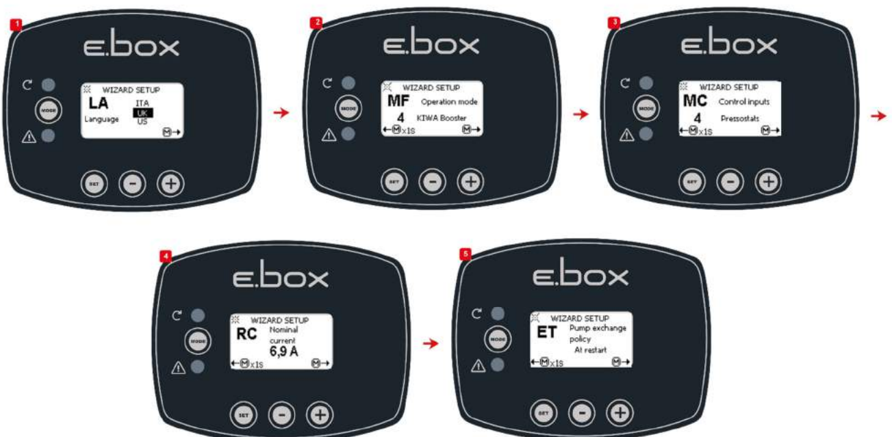
Afbeelding 49: Configuratie met Kiwa-drukschakelaars
