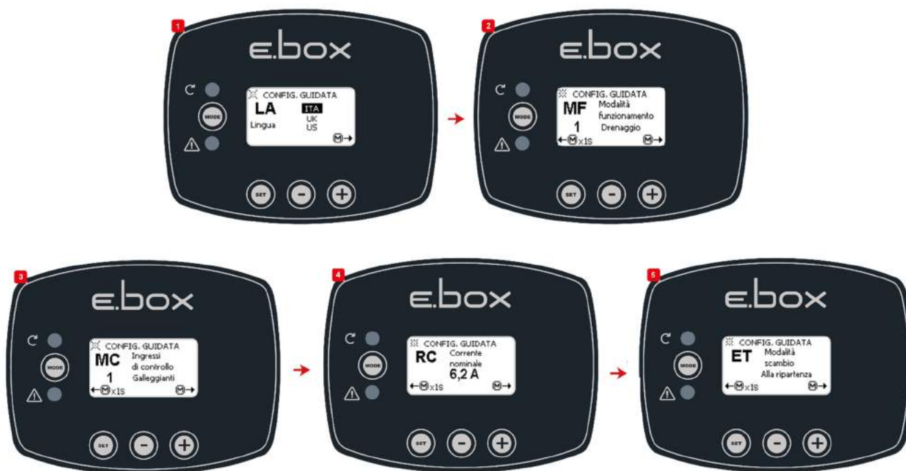
Afbeelding 36: Configuratie Ontwatering met vlotters of niveauvoelers
