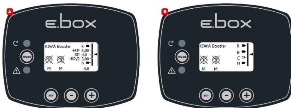
Схема 50: Состояние системы в режиме KIWA
