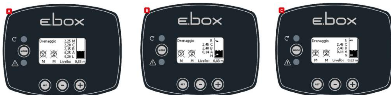
Kuva 39. Järjestelmän tila määrittämisillä: A vain syvyyssanturi, B syvyyssanturi ja uimurit, C syvyyssanturi ja tasoanturit
