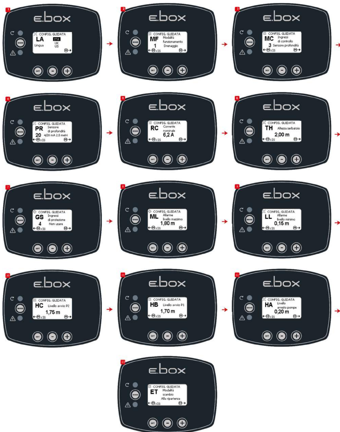
Rysunek 38: Konfiguracja tylko z czujnikiem głębokości
