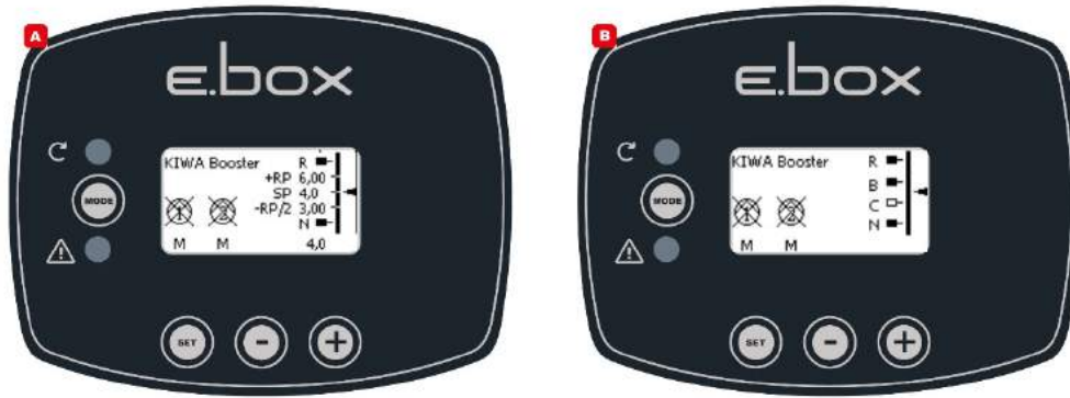
Figure 50 : État du système en mode KIWA
