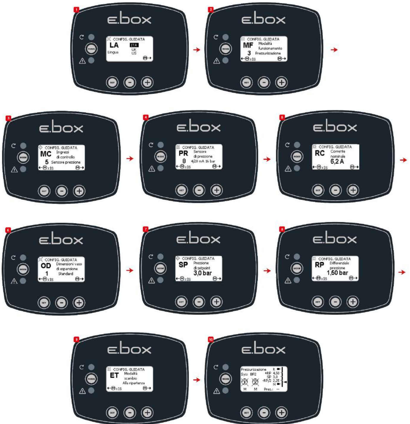
Figura 12: Configurare cu Senzor de presiune
