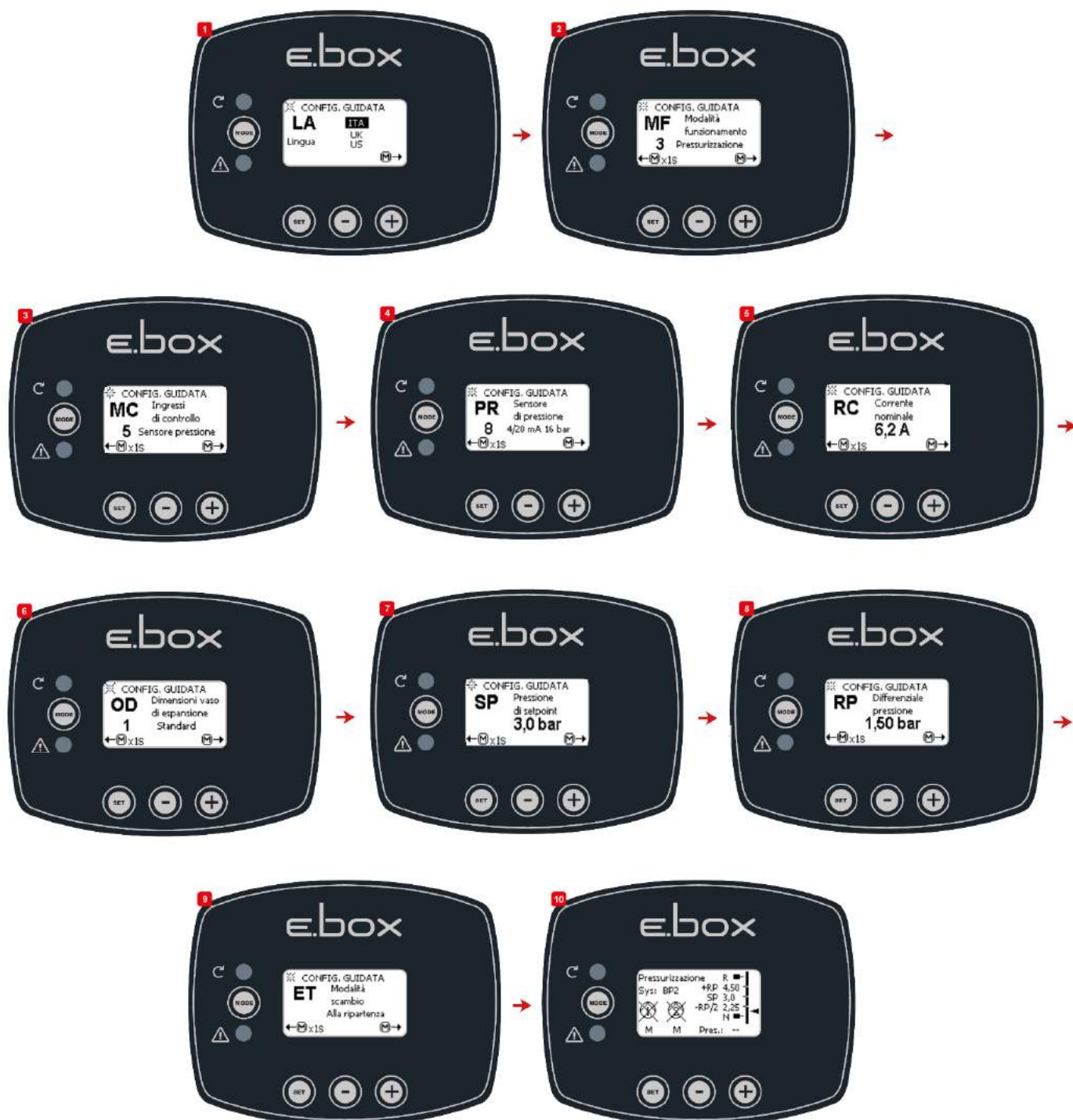
Rysunek 12: Ustawianie za pomocą czujnika ciśnienia
