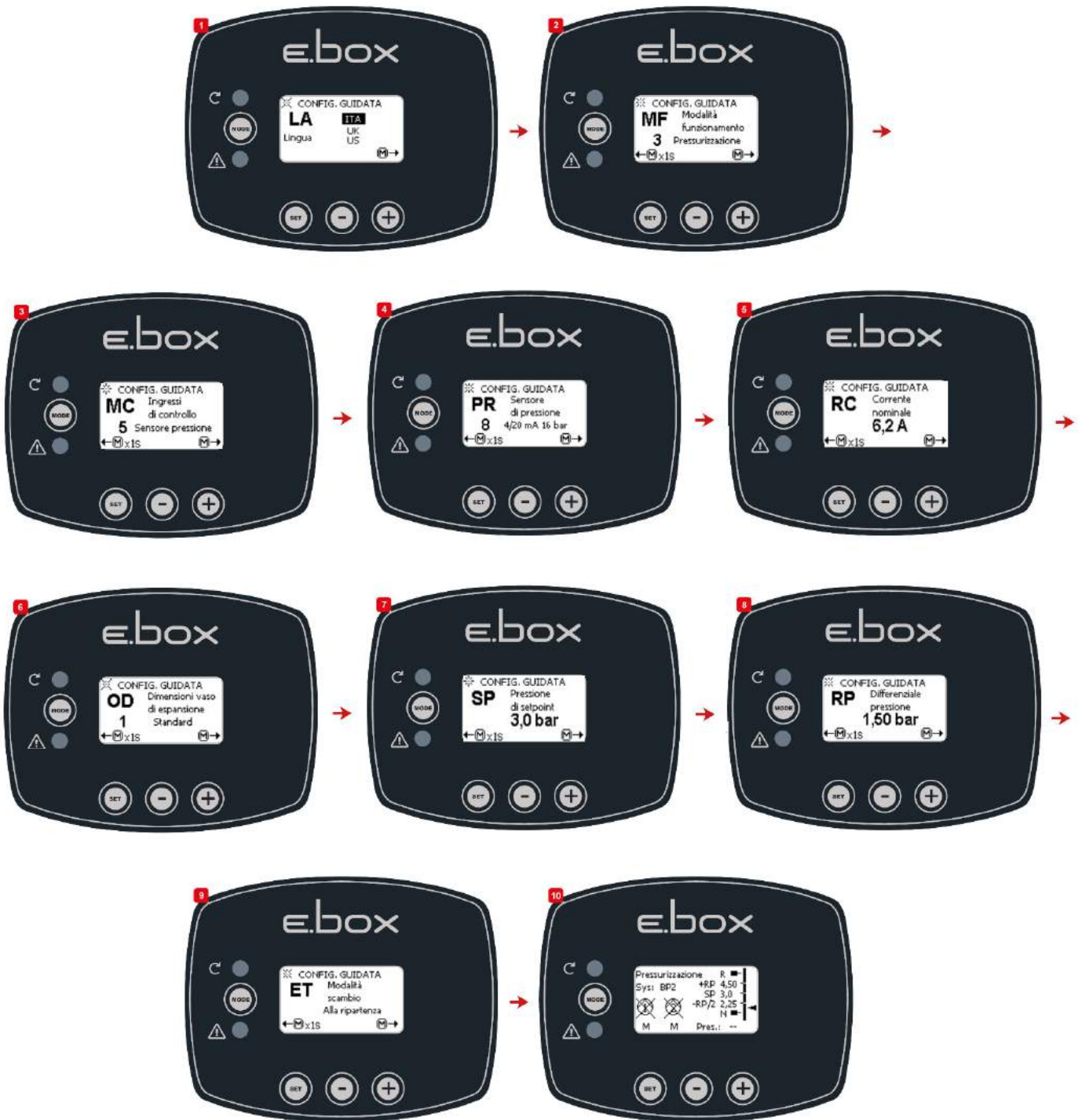
Abbildung 12: Konfiguration mit Drucksensor
