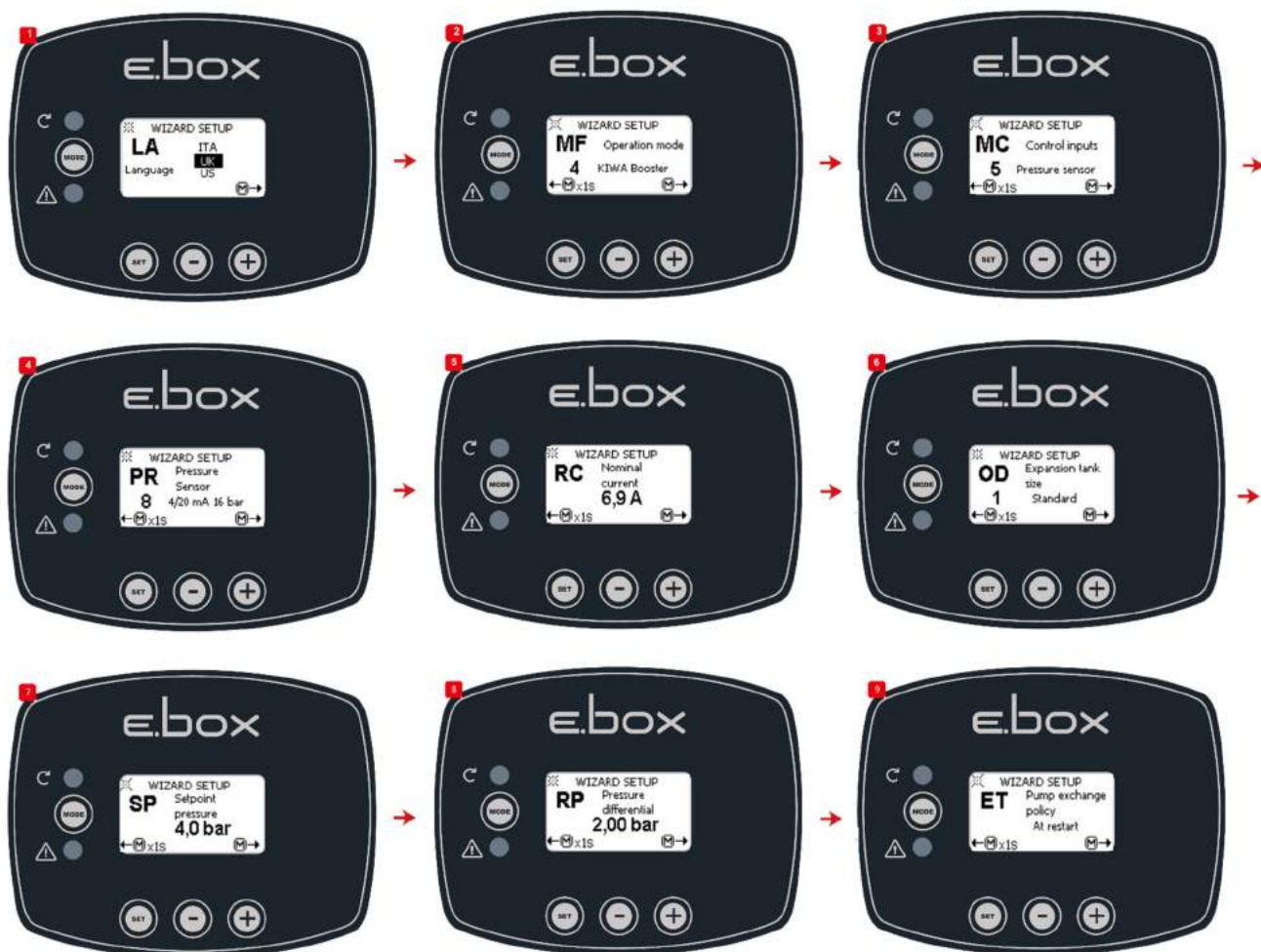
Εικόνα 48: Δημιουργία πίεσης KIWA με αισθητήρα πίεσης
