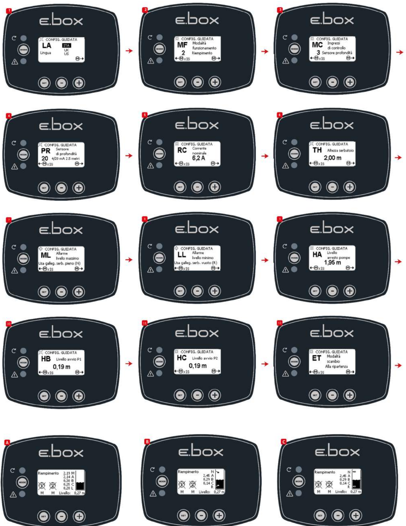
Afbeelding 26: A Staat van het systeem met alleen een dieptesensor, B dieptesensor en vlotters, C dieptesensor en niveaivoelers
