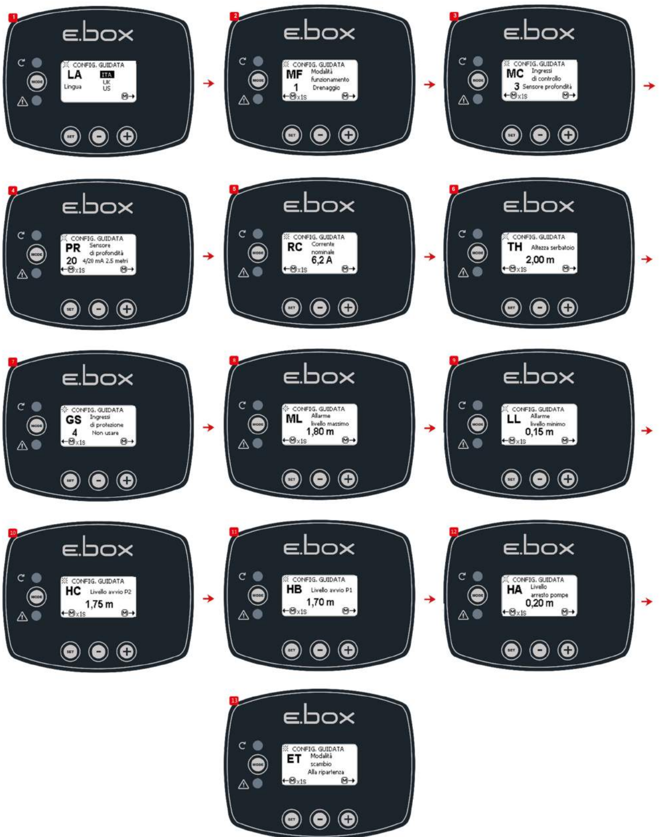
Figure 38 : Configuration avec capteur de profondeur uniquement
