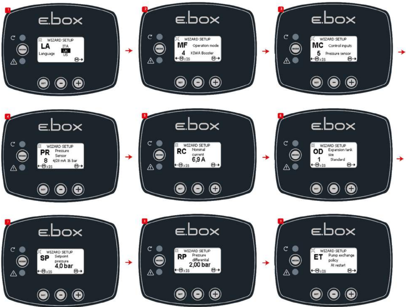
Obrázek 48: KiWA posilování tlaku s tlakovým čidlem
