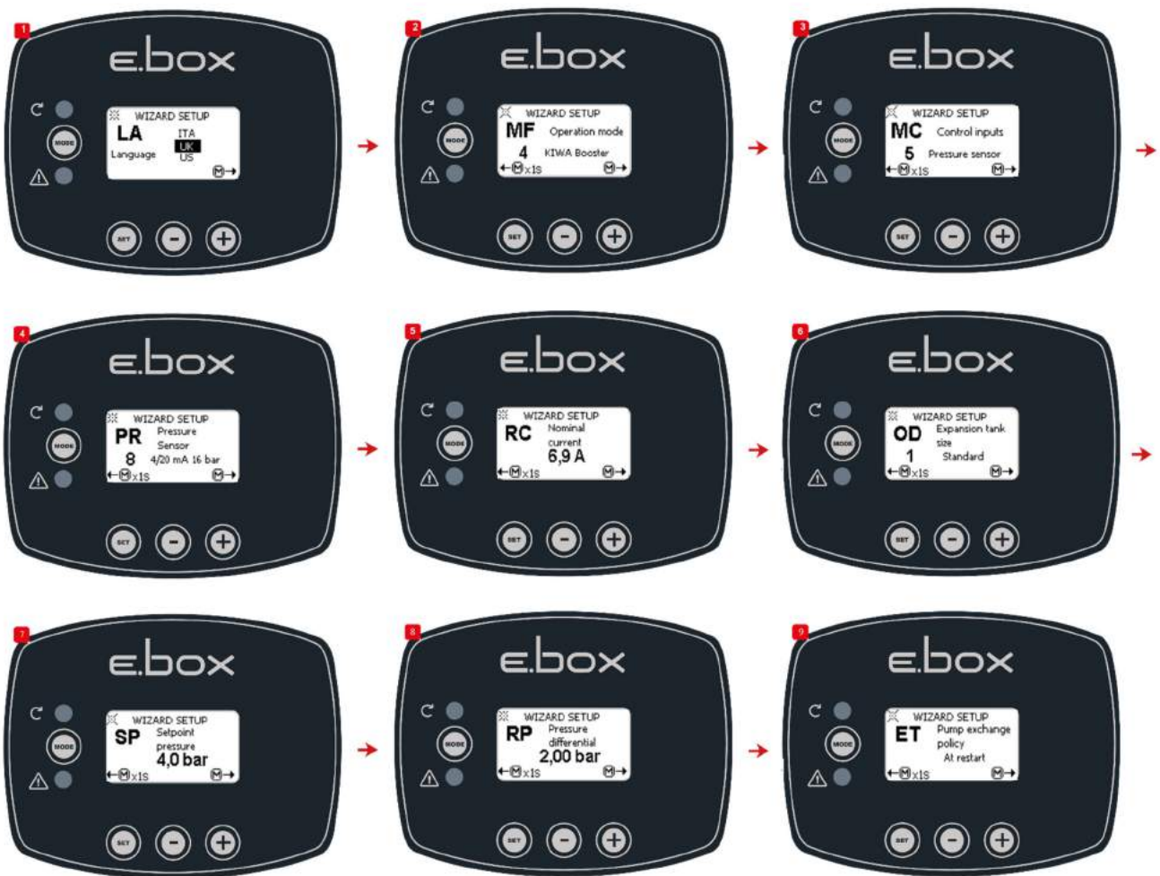
Схема 48: Подпор KIWA с датчиком давления
