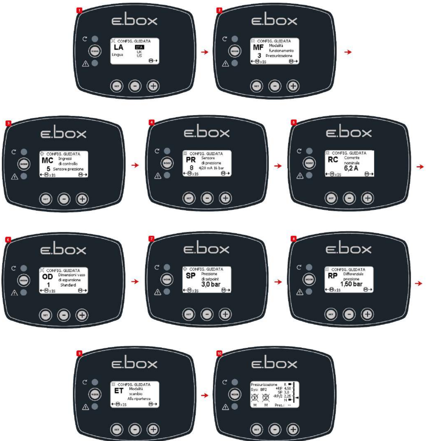
Figure 12 : Configuration avec capteur de pression
