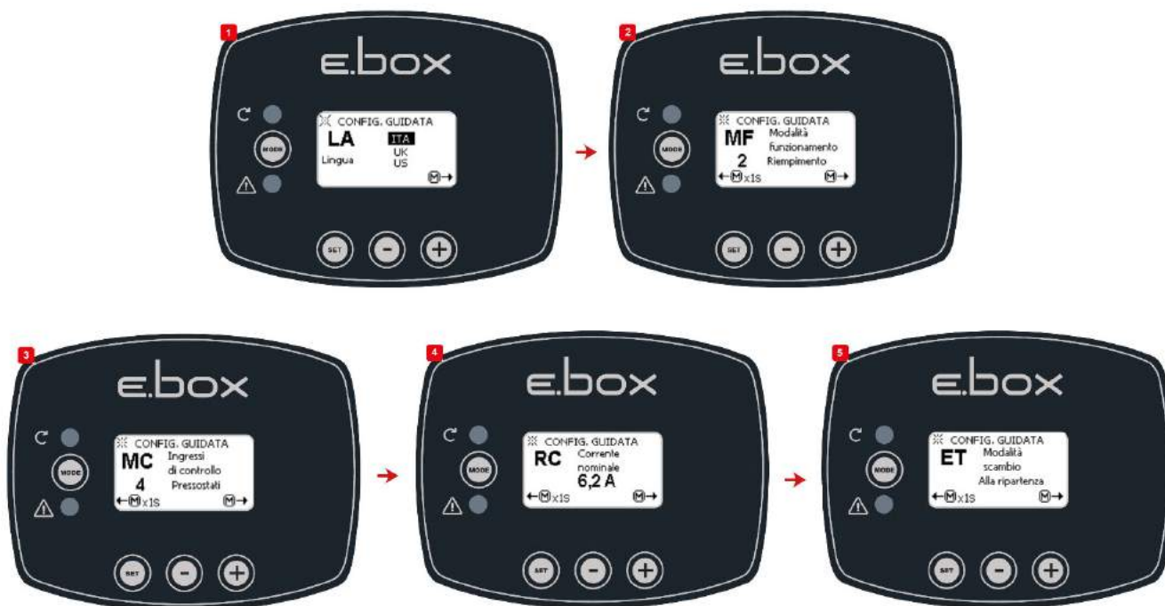
Εικόνα 24: Διαμόρφωση πλήρωσης με πλωτήρες ή αισθητήρια στάθμης
