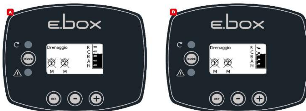
Kuva 37. Järjestelmän tila tyhjennyksessä, A tasoantureilla, B uimureilla
