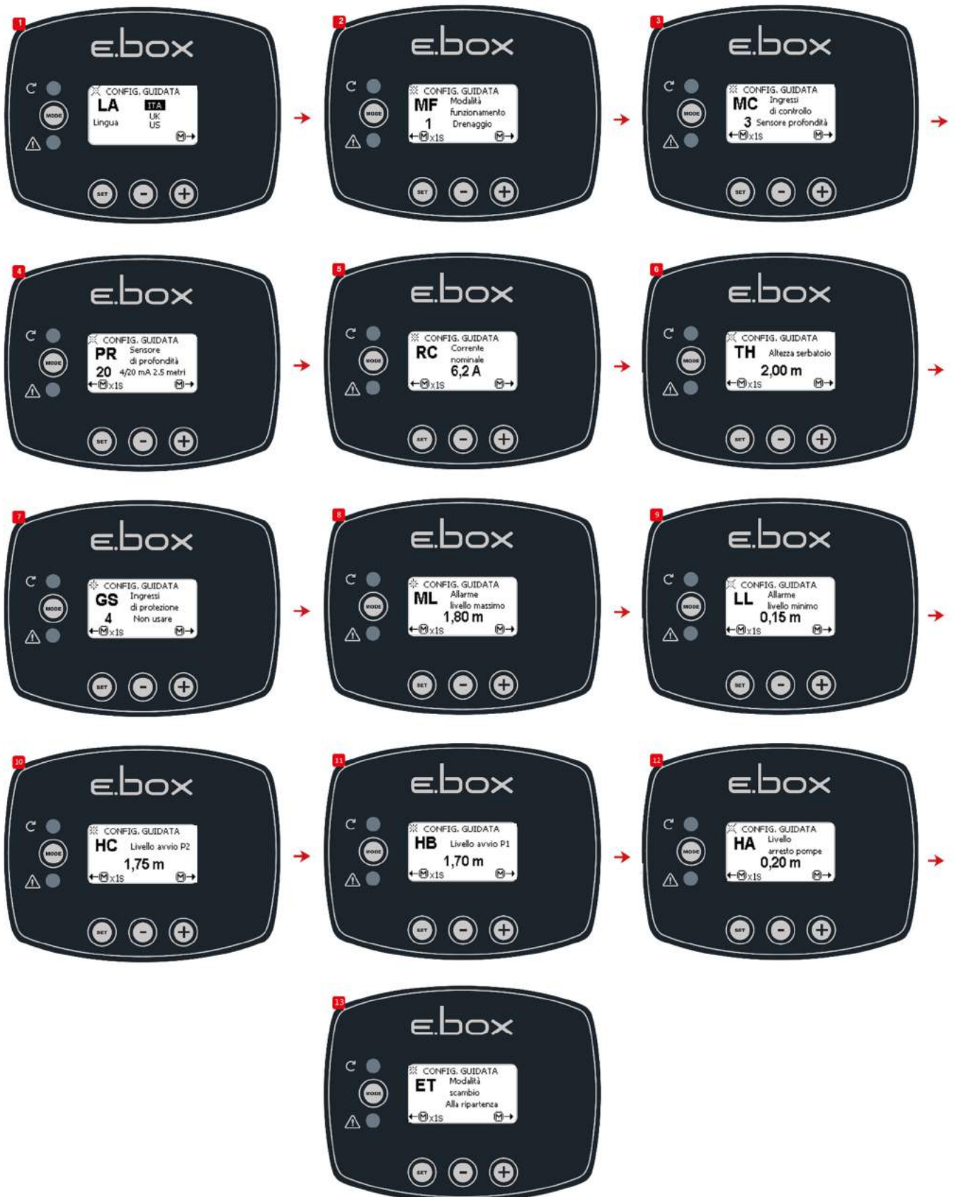
Figura 38: Configurazione con solo sensore di profondità
