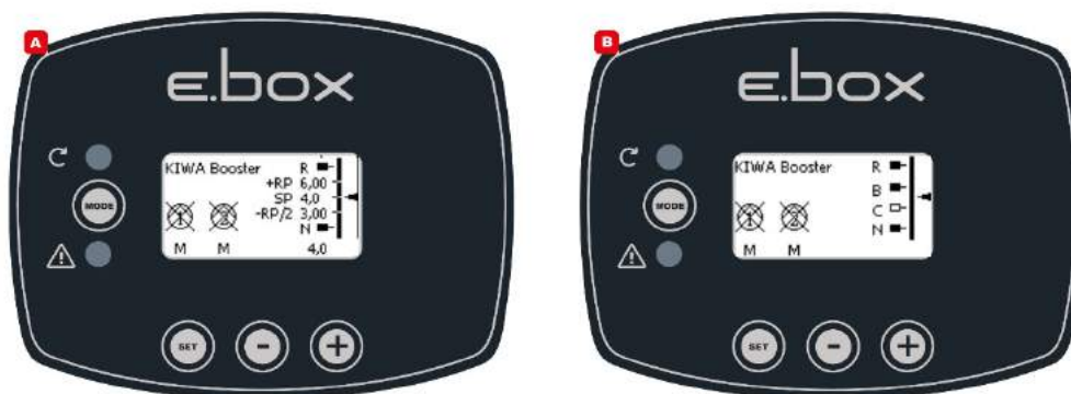
Kuva 50. Järjestelmän tila KIWA-tilassa
