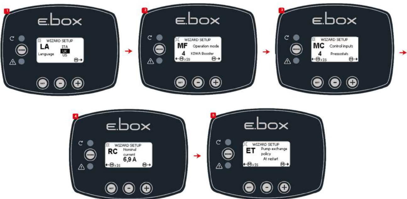
Figure 49 : Configuration KIWA avec des pressostats
