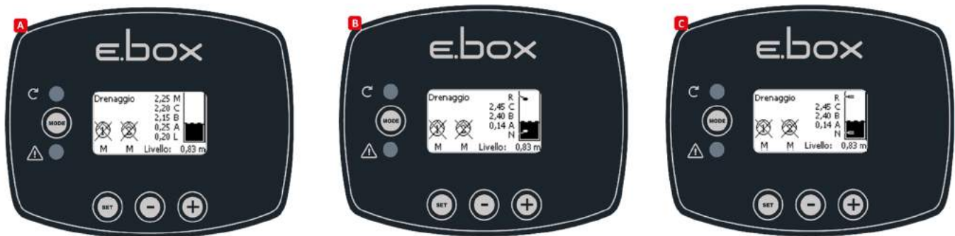
Afbeelding 39: Staat van het systeem in de configuraties: A alleen met een dieptesensor, B dieptesensor en vlotters, C dieptesensor en niveauvoelers
