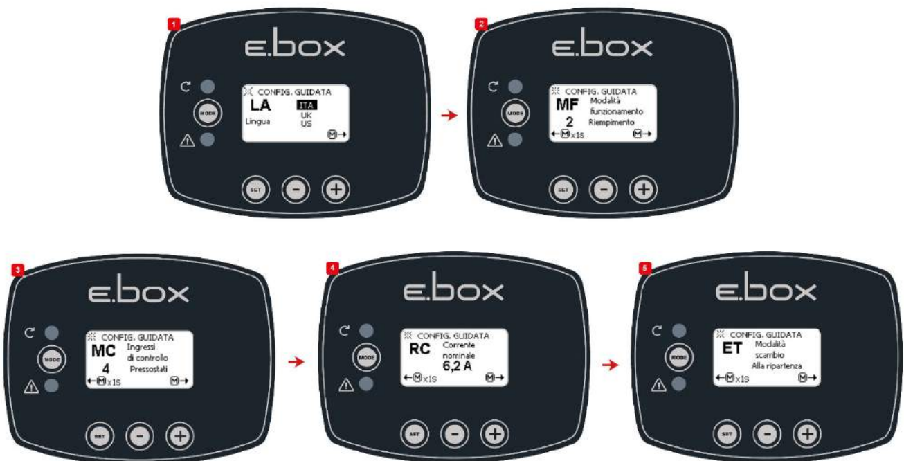
Abbildung 24: Füllkonfiguration mit Schwimmerschaltern oder Standsonden
