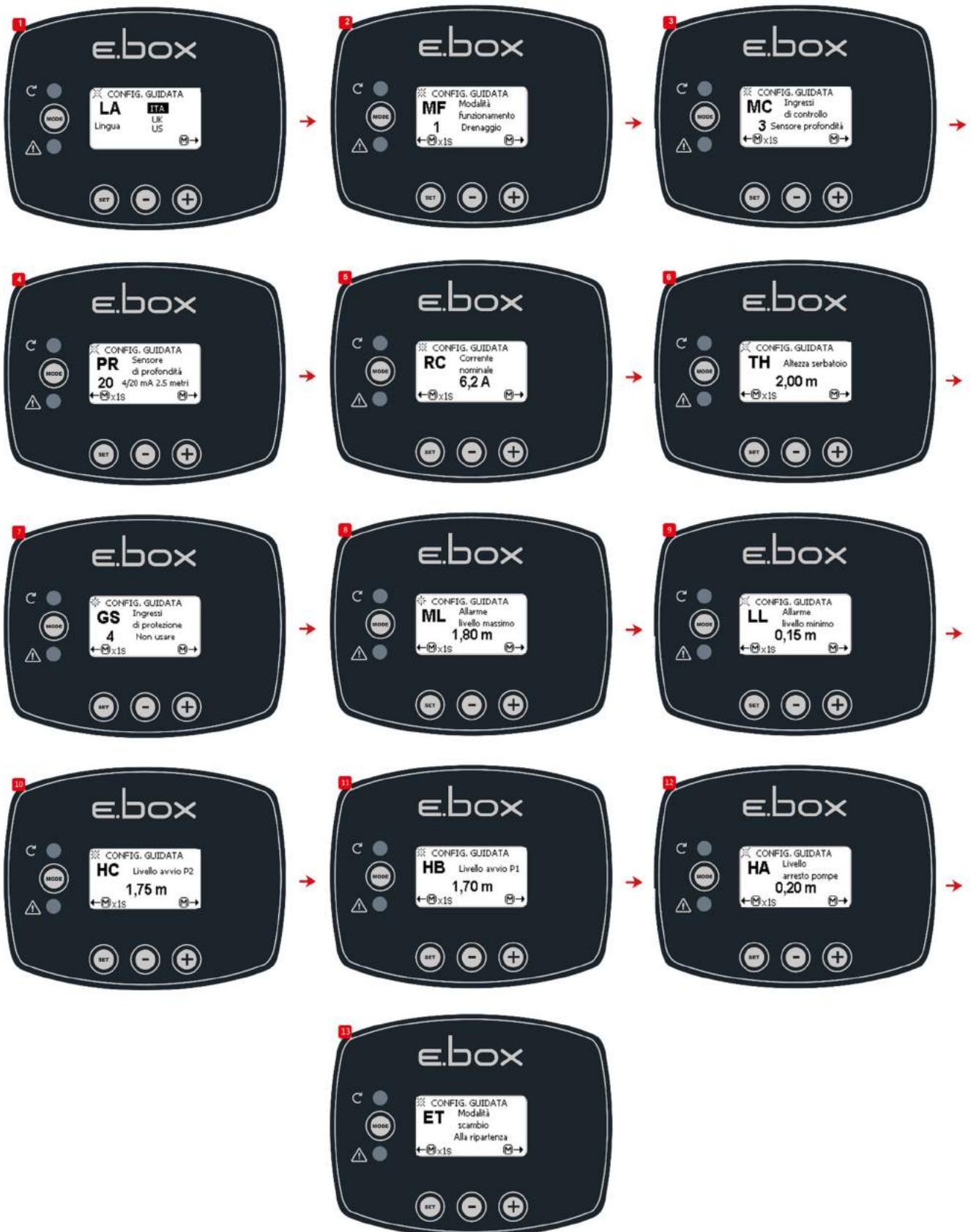
Kuva 38. Määrittys vain yhdellä syvyysanturilla
