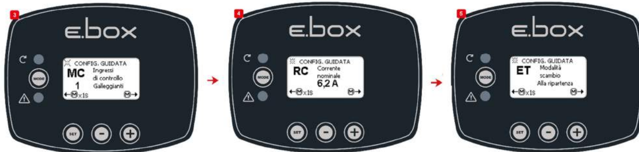
36.ábra: Drenázs működési módnál az úszókapcsolók vagy szintszondák konfigurálása
