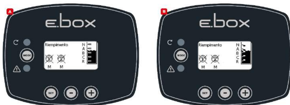
Abbildung 25: Status des Systems in Füllmodus mit Eingängen für die Kontrolle von Schwimmerschaltern oder Standsonden
