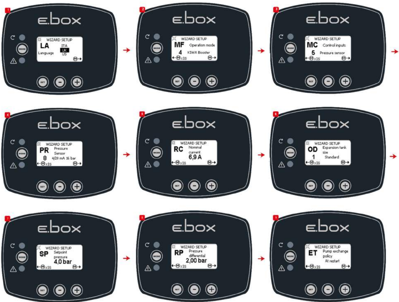
Figure 48 : Pressurisation KIWA avec capteur de pression
