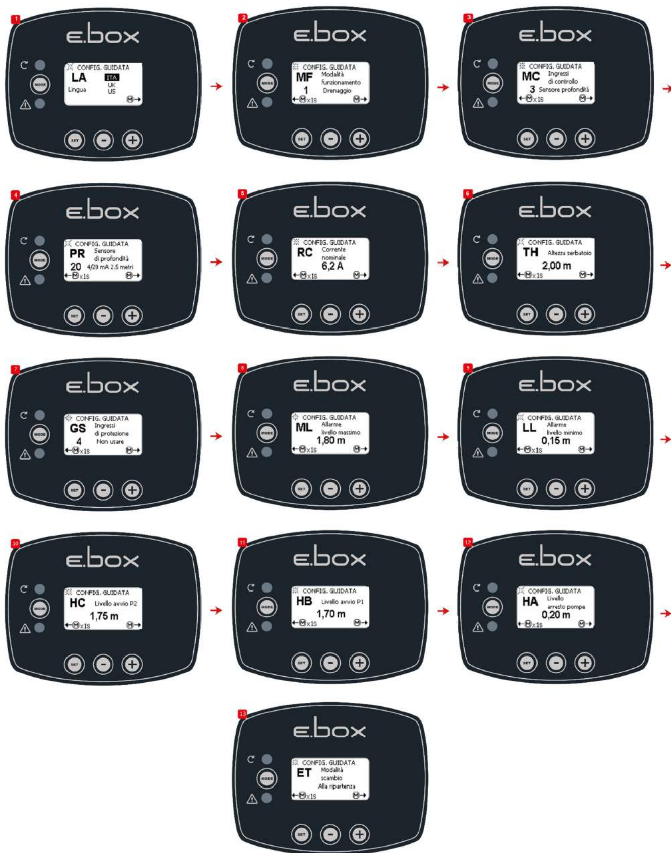
Εικόνα 38: Διαμόρφωση με μόνο αισθητήρα βάθους
