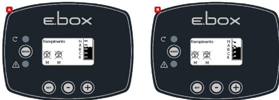
Afbeelding 25: Staat van het systeem in de vulmodus, met controle-ingangen van vlotters of niveaivoelers
