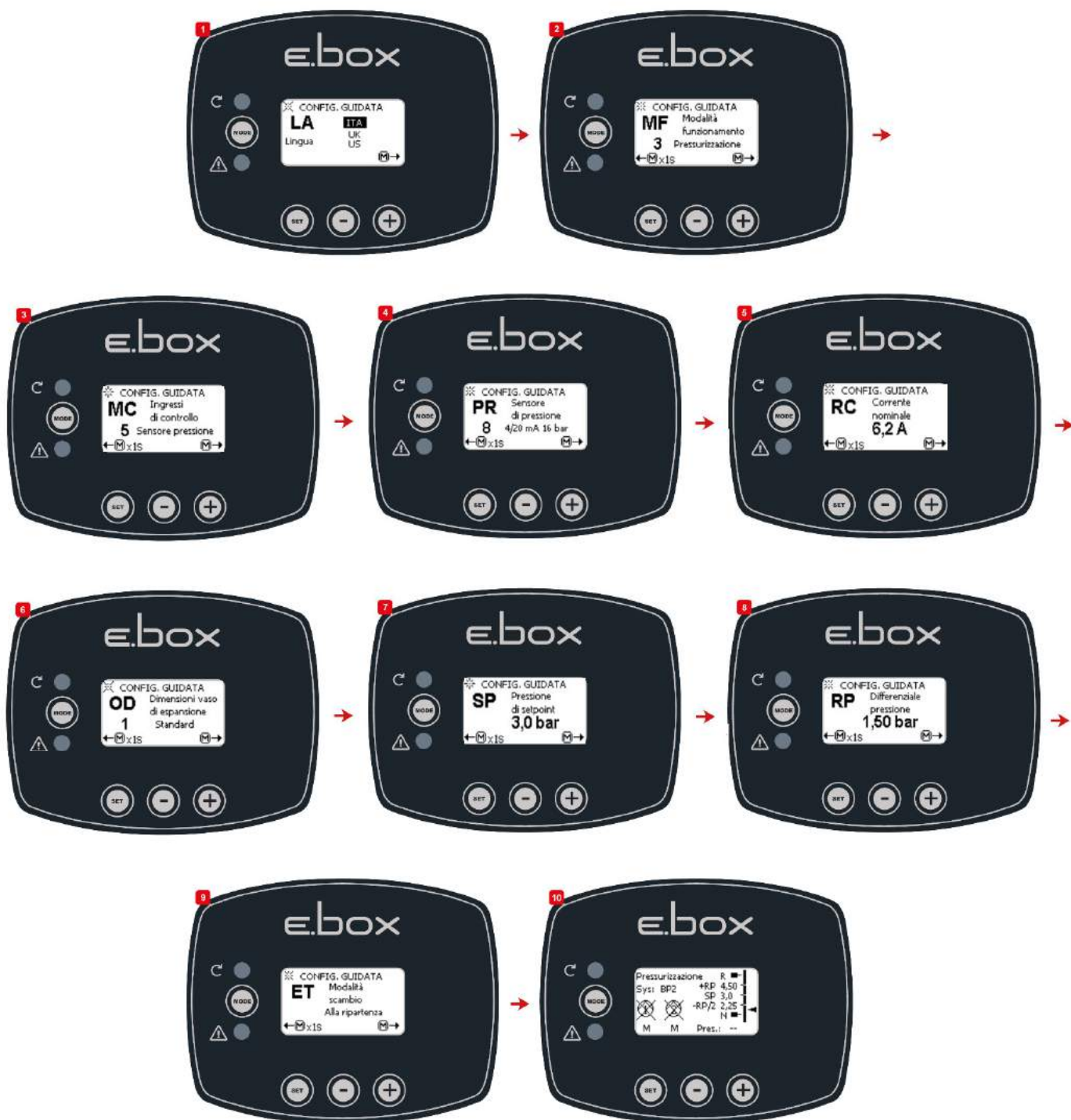
Εικόνα 12: Διαμόρφωση με Αισθητήρα πίεσης
