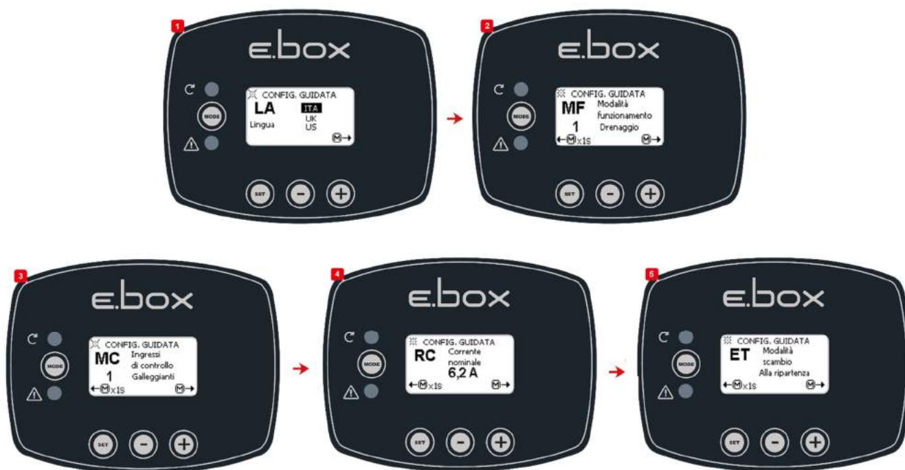
Rysunek 36: Konfiguracja pływaków lub sond poziomu Drenażu
