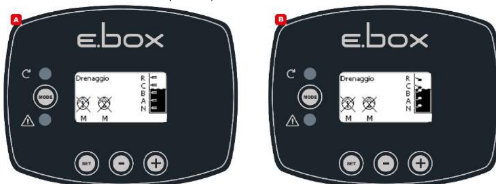
37.ábra: A rendszer státusza drenázs módban: A= szintszondákkal B= úszókapcsolókkal
