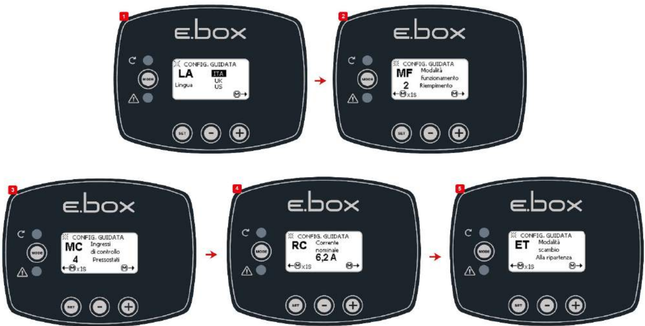
Afbeelding 24: Configuratie Vullen met vlotters of niveaivoelers
