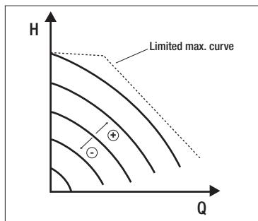
Esta regulación muestra la curva de la bomba a velocidad constante. La curva se selecciona configurando la velocidad de rotación o un porcentaje de reducción. El 100% indica la curva máxima. La velocidad de rotación depende de la potencia y de la presión diferencial en función del modelo. La velocidad de rotación se puede ajustar en el display o mediante una señal externa 0-10V o PWM.
