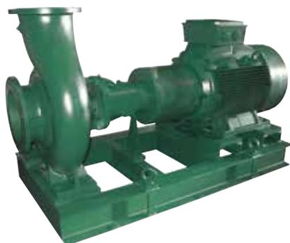
Bomba centrífuga con cuerpo en espiral monocelular no auto aspirante, con boca de aspiración axial, boca de impulsión radial y eje horizontal. Las bombas KDN tienen dimensiones y prestaciones nominales según la norma EN 733 (10 bar), pero están diseñadas para el funcionamiento con 16 bar si el tipo de cierre mecánico lo permite.
