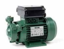
Cuerpo de la bomba, soporte del motor y rodete de latón. Cierre mecánico en carbón/cerámica. Eje motor de acero inoxidable. Motor asíncrono, cerrado y refrigerado por ventilación externa.
