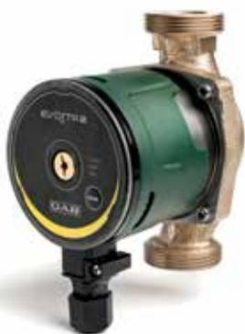
Circulador electrónico de rotor húmedo diseñado para la circulación de agua caliente sanitaria en sistemas domésticos y residenciales. Electrónica resistente al agua (IPX5). Motor síncrono de imanes permanentes. Electrónica con inverter que adapta automáticamente el rendimiento de la bomba a los requisitos del sistema, lo que ahorra energía y protege a la instalación contra golpes de ariete.
