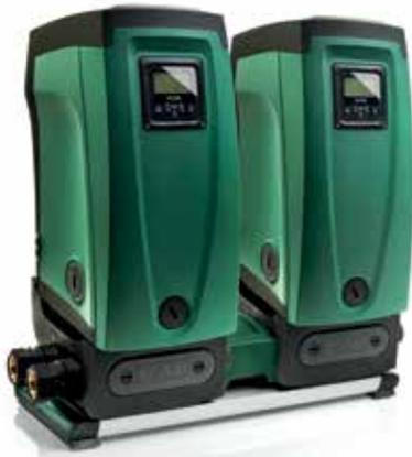
2EsyBox con EsyDock Twin es el grupo electrónico para la presurización hidráulica en instalaciones domésticas y residenciales. 2EsyBox con EsyDock Twin no requiere ningún componente adicional para su instalación. Se compone de dos bombas multicelulares auto aspirantes con electrónica inverter, sensores de presión y flujo, display LCD orientable de alta resolución y un vaso de expansión de 2 litros (uno por bomba).
